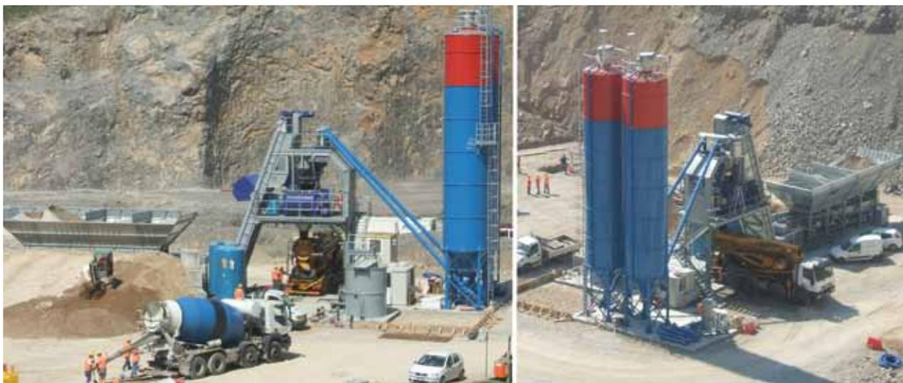
Мобильная бетоносмесительная установка типа **Fast 100**
