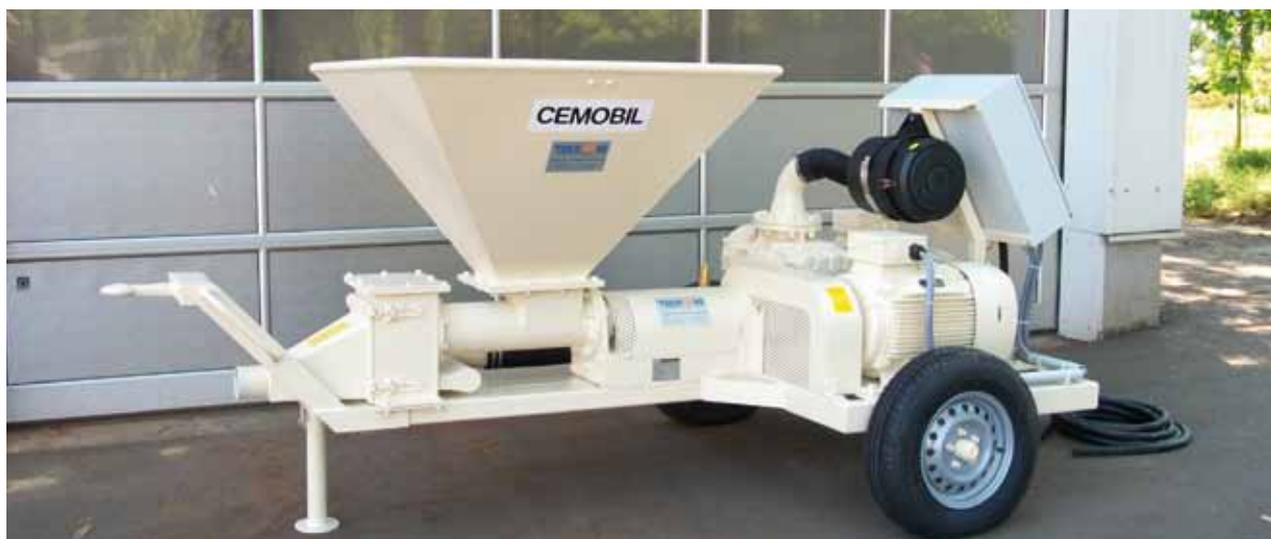
Компактная мобильная установка типа **Cemobil** для ручной выгрузки мешков с последующей пневмотранспортировкой в силос
