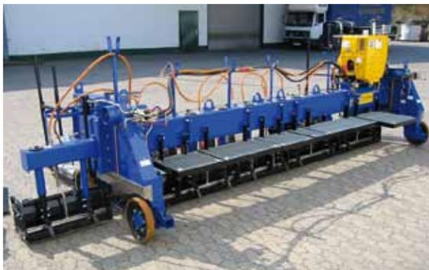
Укладчик литого асфальта типа **EB 25-40**
