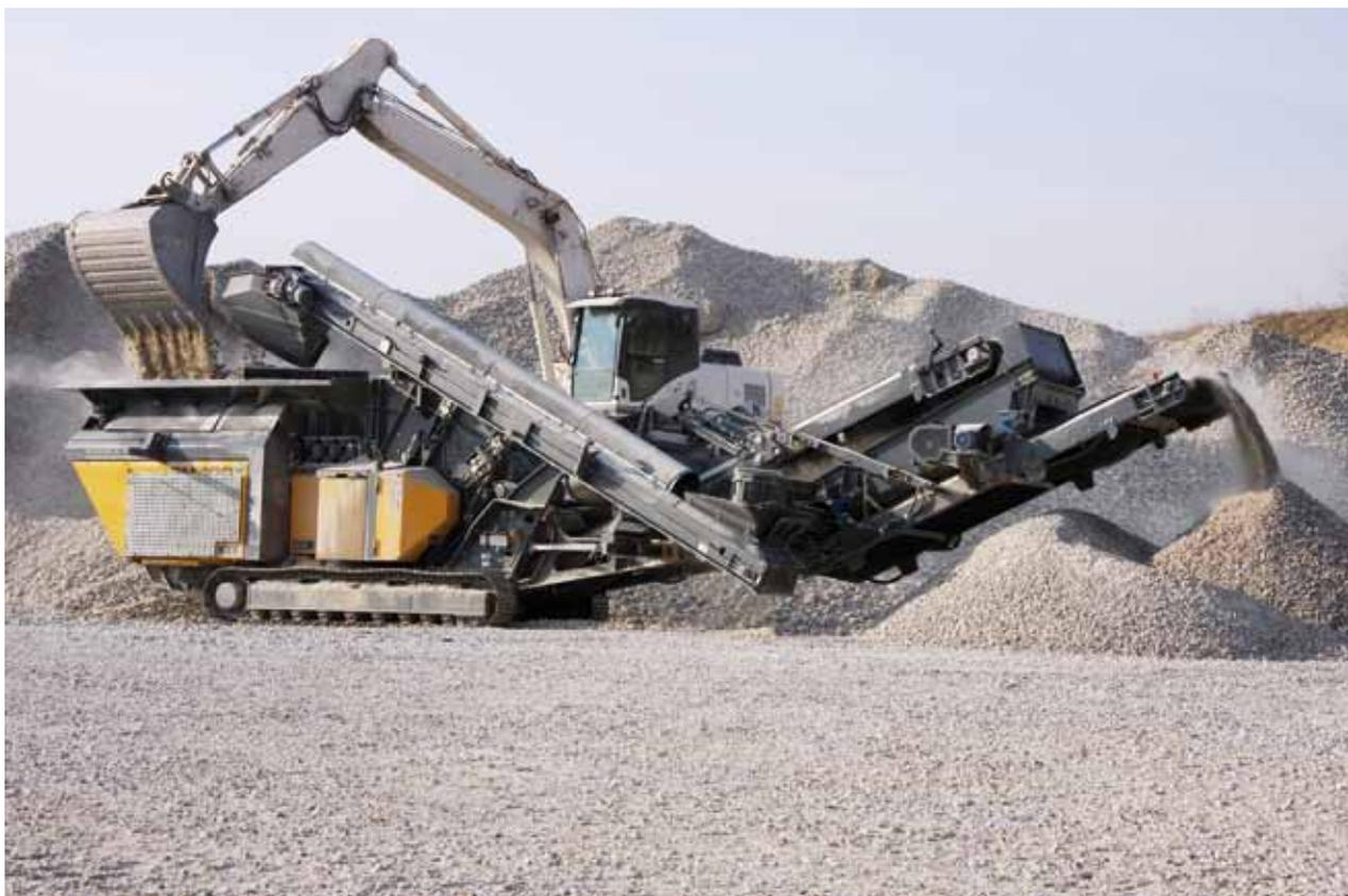
Мобильная роторная дробильная установка типа **RM100GO!**
