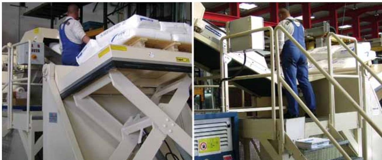
Оборудование для беспыльной выгрузки большого количества мешков типа **Cematic**
