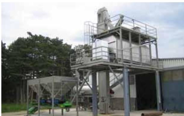
Установка для производства литого асфальта типа **GA 1.000**
