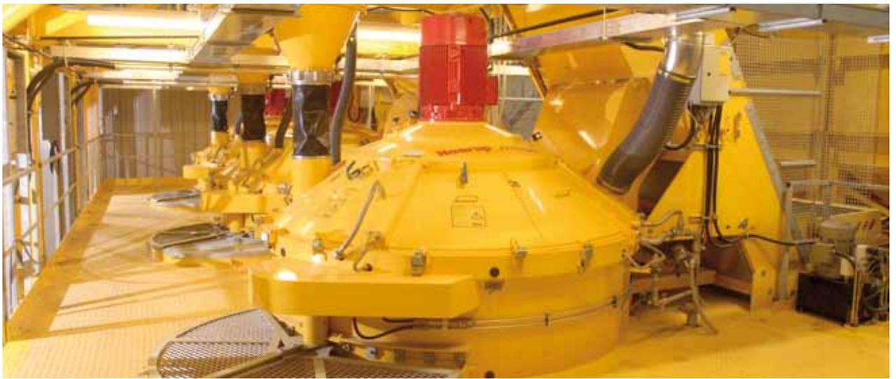
Три планетарных противоточных смесителя типа **Haarup 2.250** для тяжёлых бетонов
