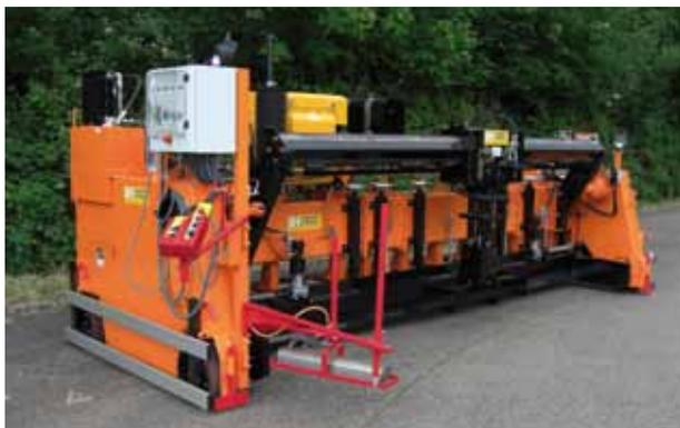
Укладчик литого асфальта типа **EB 50-75**
