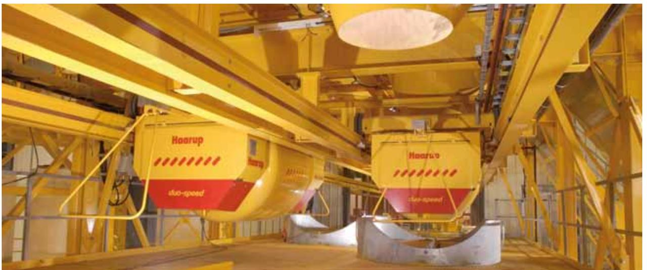
Различные системы транспортировки готового бетона к местам раздатки на заводах ЖБИ
